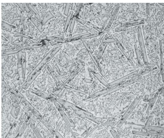
**Рис. 5.** Микроструктура Al-Si лигатуры, синтезированной из алюмоматричной композиции на основе системы Al-SiO<sub>2</sub>, с содержанием Si 28,6 %, ×50
