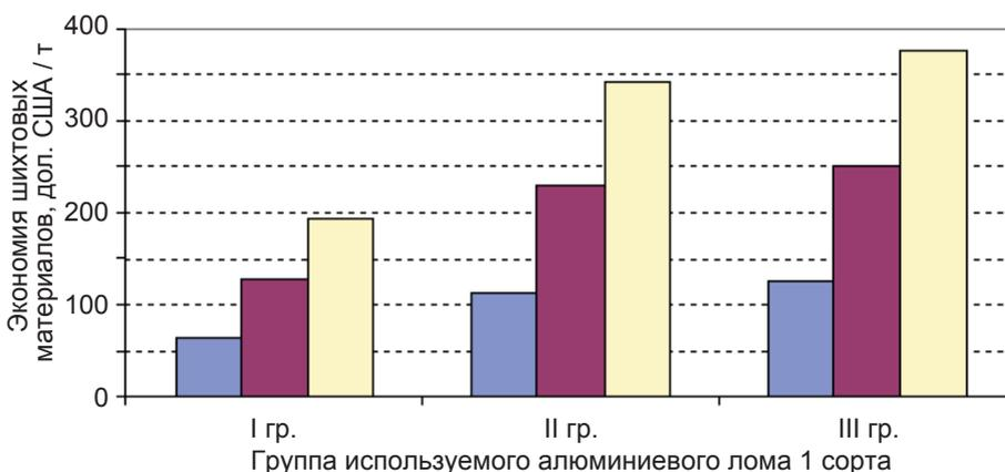
**Рис. 1.** Экономия шихтовых материалов при получении сплавов системы Al-Si из лома и отходов алюминиевых сплавов I-III групп с использованием формовочного кварцевого песка марки 2K<sub>2</sub>O<sub>2</sub>03 взамен кристаллического кремния в ценах на 01.09.2012, (% Si): ■ – 10; ■ – 20; □ – 30
