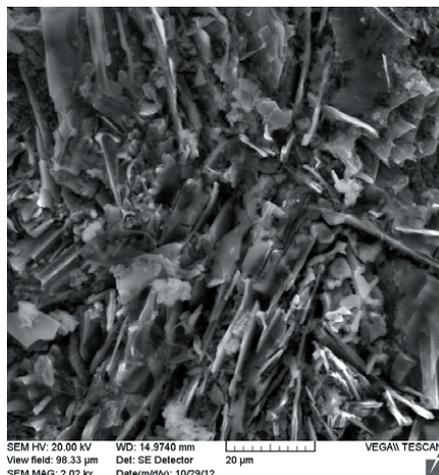
на рис. 4. Пластины кристаллов эвтектического кремния в синтетическом сплаве характеризуются меньшей толщиной и более компактным пространственным расположением по сравнению с образцами сплавов, полученными по традиционной технологии сплавления алюминия с кристаллическим кремнием.
