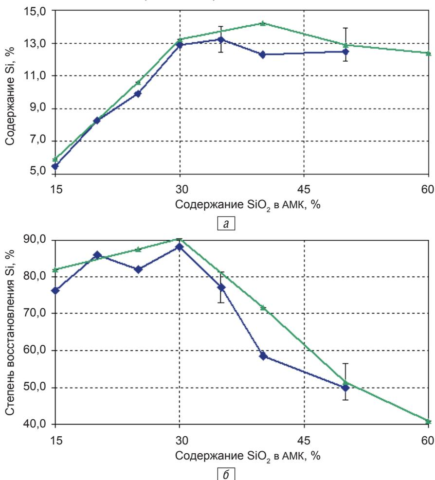
**Рис. 2.** Влияние количества вводимого кварцевого песка в АМК с различным содержанием магния в алюминиевой матрице на содержание (а) и степень восстановления (б) кремния в синтетическом сплаве системы Al-Si: ■ АМК Al-SiO<sub>2</sub> ▲ АМК Al-1%Mg-SiO<sub>2</sub>
