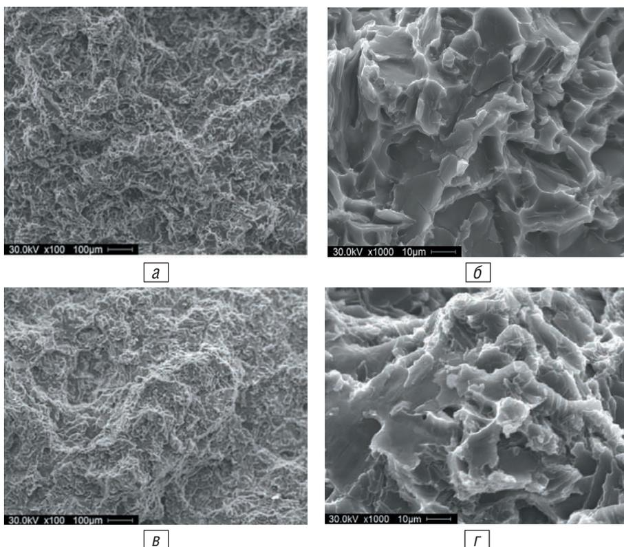
**Рис. 3.** Фрактограммы изломов сплавов АК9, полученных сплавлением алюминия и кристаллического кремния (а, б) и синтезированного из АМК (в, г);  $\times 100$  (а, в),  $\times 1000$  (б, г)
