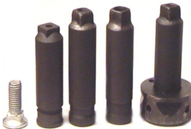
**Рис. 1.** Электроды-инструменты для обработки квадратного отверстия с фаской
