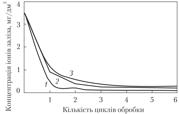
Рис. 3. Залежність зміни концентрації іонів заліза у воді від кількості циклів обробки за швидкостей обертання ротора: 1 – 55; 2 – 45; 3 – 35 об/с
