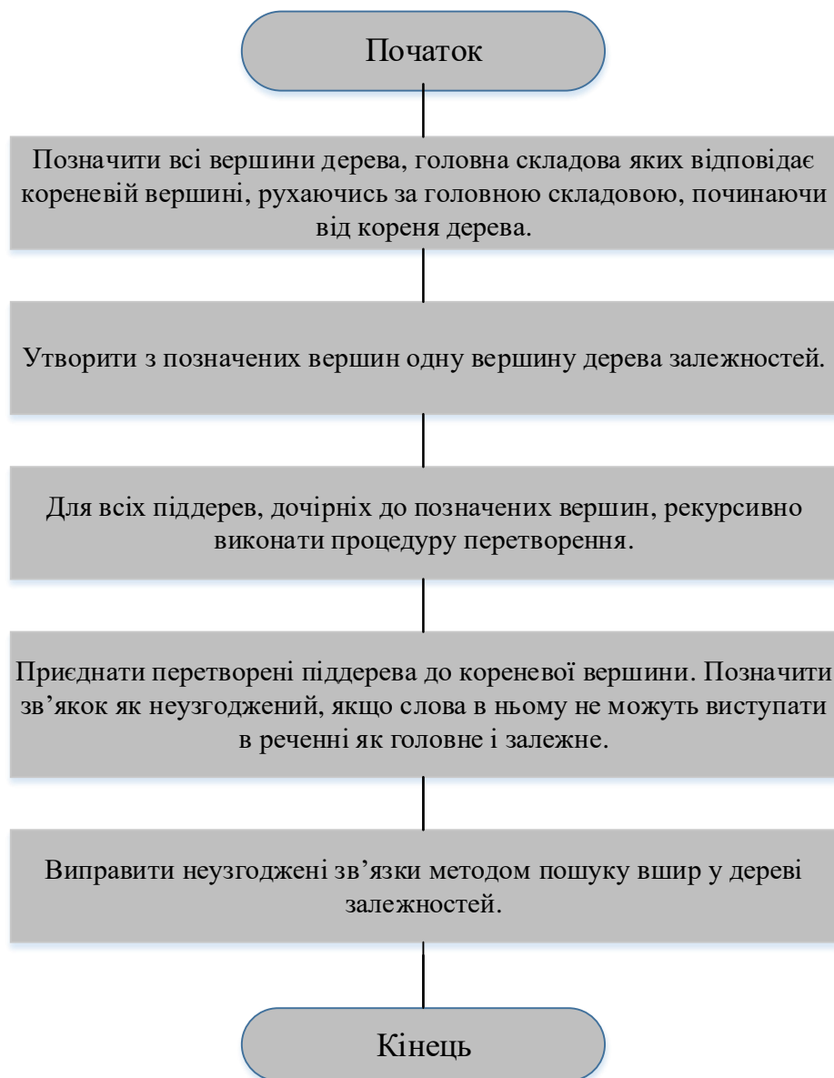
Рис. 1. Блок-схема алгоритму трансформації дерева складових у дерево залежностей
