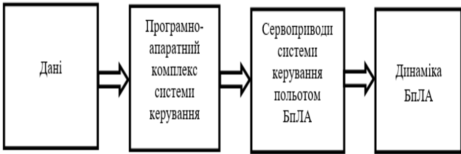
Рис. 1. Функціональна структура апаратно-програмного комплексу системи керування БПЛА
