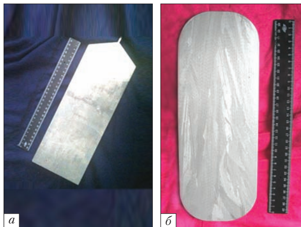
Рис. 1. Пластина оптичного германію (а) та виготовлене з неї вхідне вікно (б) для інфрачервоної техніки
