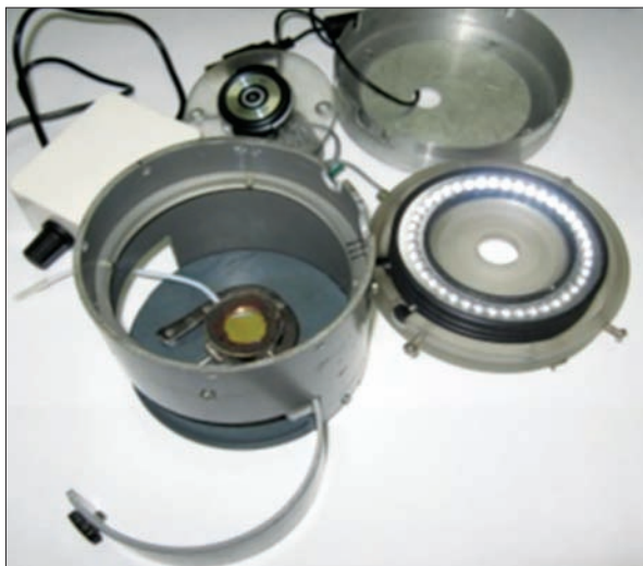
Рис. 5. Багатоелементний колориметричний аналізатор з круговим світлодіодним джерелом світла
