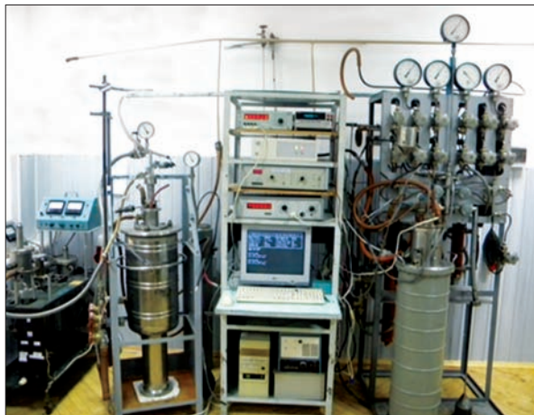
Рис. 10. Метрологічна установка для високоточного градування та повірки сенсорів температури з рекордною точністю градування
