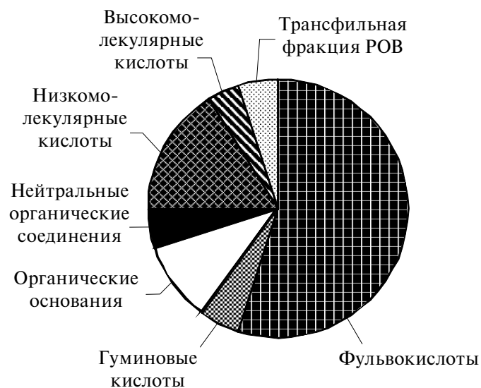
Рис. 1. Диаграмма распределения растворенного C_{org} среди различных групп органических веществ в типичной речной воде ( C_{org} = 5 \text{ мг/дм}^3 ) [6].
