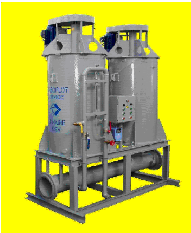
Рис. 12. Игольчато-дисковый флокулятор для обработки концентрированных суспензий
