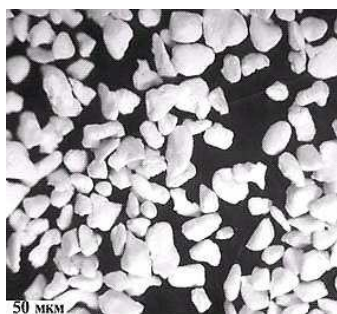
Рис. 2. Порошки системы ZrO_2-Y_2O_3-CeO_2 для обработки имплантатов. 3
