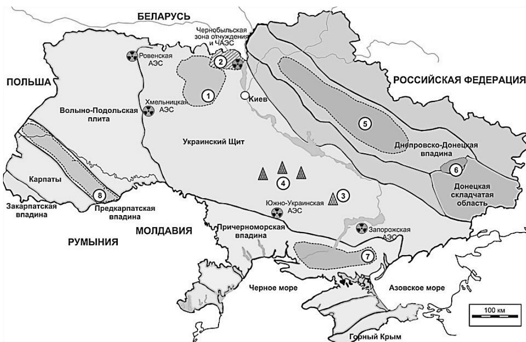
Рис. 3. Расположение на территории Украины формаций, структур и объектов, перспективных для геологического захоронения РАО: 1 — Коростенский плутон (протерозойские гранитоиды); 2 — Чернобыльская зона отчуждения (архейские и протерозойские кристаллические формации); 3 — железорудная шахта «Саксагань» (архейские гранитоиды); 4 — урановые шахты (протерозойские кристаллические формации); 5 — солянокупольные структуры Днепровско-Донецкой впадины; 6 — пластовые соли Донецкой складчатой области; 7 — глинистые формации Причерноморской впадины; 8 — галогенные и глинистые формации Предкарпатского прогиба
