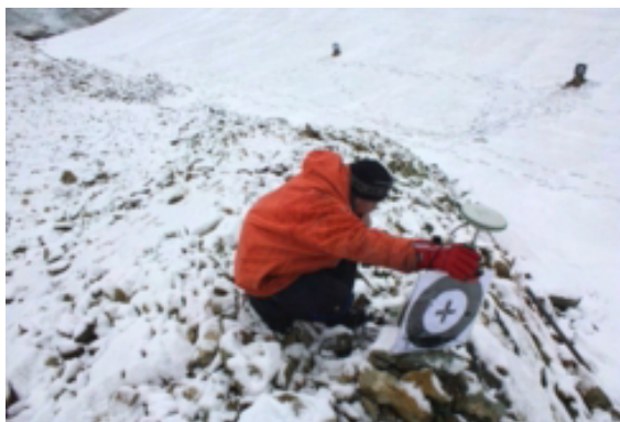
Рис. 7. Визначення координат опорних марок методом ГНСС.
