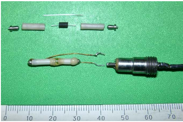
Рис. 3. Последовательность сборки (см. текст) и устройство камеры высокого давления для заполнения наноканалов асбеста жидким металлом и проведения измерений.
