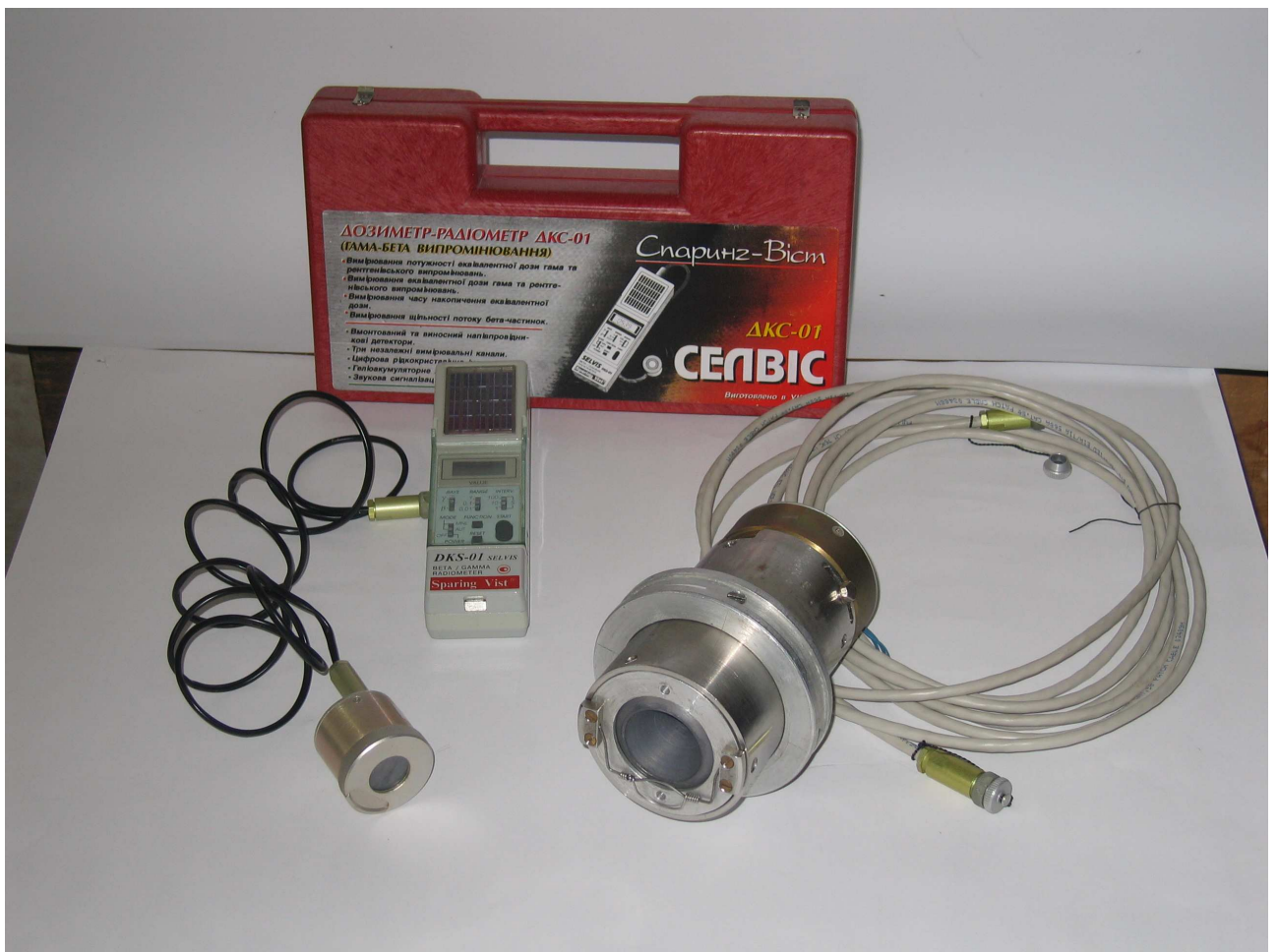
Рис. 2. Коллимирующее устройство на основе дозиметра-радиометра ДКС-01 "Селвис".
