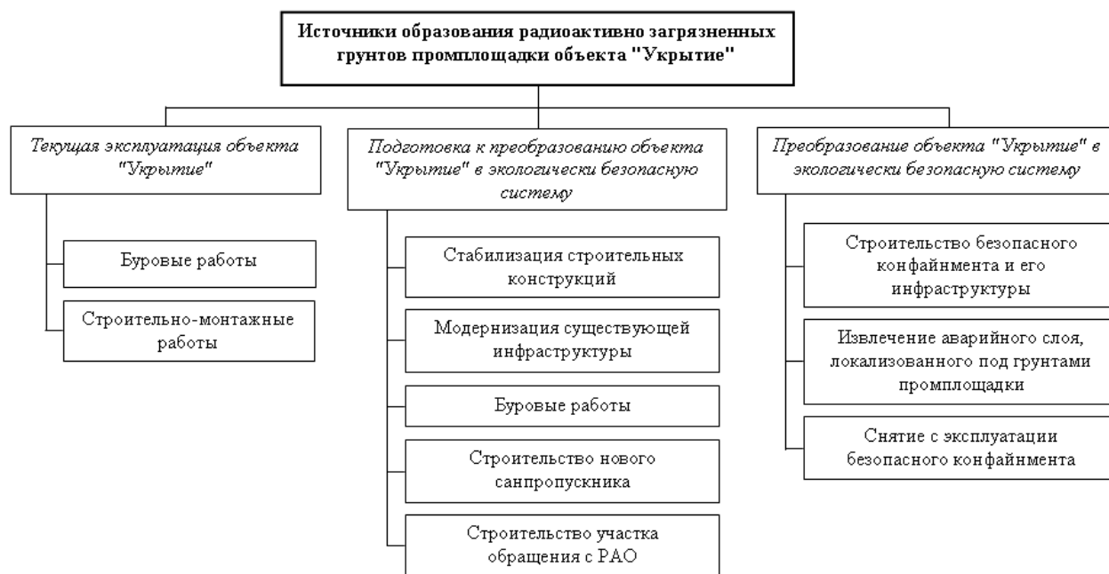
Рис. 1. Источники образования радиоактивно загрязненных грунтов при производстве земляных работ вблизи объекта "Укрытие" в процессе преобразования его в экологически безопасную систему.
