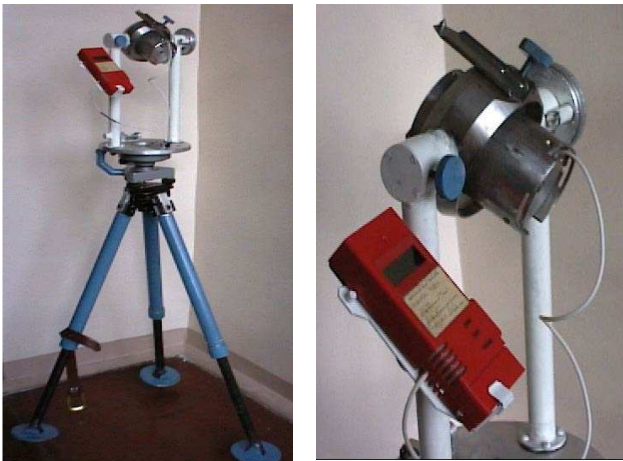
Рис. 2. Общий вид устройства ДКС-04К (дозиметр ДКС-04 с коллиматором).
