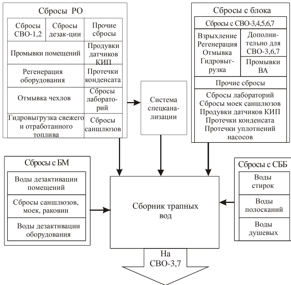
Рис. 4. Принципиальная схема связей спецводоочистки Южно-Украинской АЭС: РО – реакторное отделение; БМ – блок мастерских; СББ – санитарно-бытовой блок; ВА – выпарные аппараты; КИП – контрольно-измерительные приборы.
