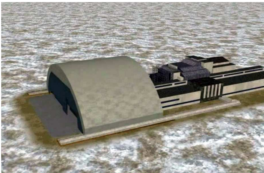
Рис. 40. Перемещение арочной конструкции в проектное положение.
