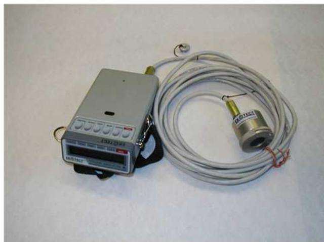
Рис. 2. Прибор МКС-07 "Пошук" с выносным блоком детектирования бета-частиц БДИБ-10.
