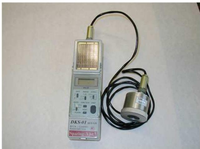
Рис. 1. Прибор ДКС-01М "Селвис" с выносным блоком детектирования бета-частиц БДИБ-01К.
