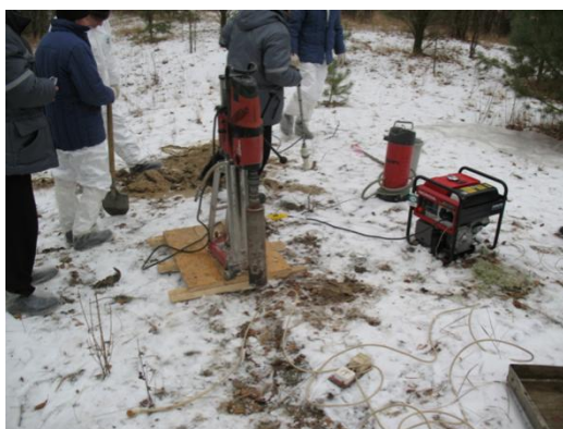
Рис. 2. Бурение разведочных скважин на объекте 2 и результаты гамма-каротажа.
