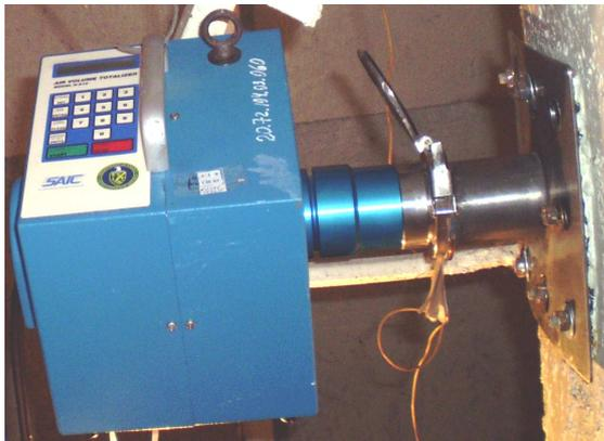
Рис. 4. Отбор пробы аэрозолей воздуходувкой Н810 SAIC в системе «Байпас».
