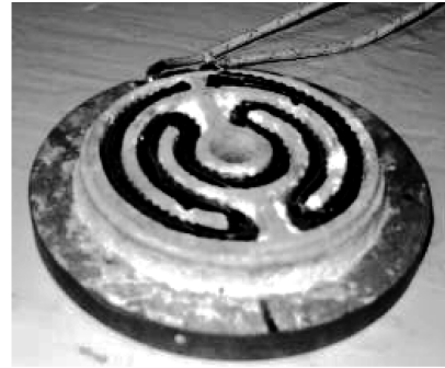
Рис.1. Зовнішній вигляд зразка в каналах керамічної основи електронагрівача.
