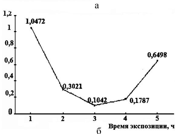
Рис. 3. Зависимость скорости коррозии свинца от времени выдержки в растворе электролита при статическом режиме, °С: а — 20; б — 60.
