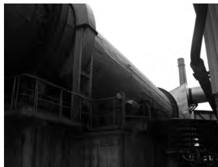
Рис.3. Вращающаяся барабанная сушилка.
