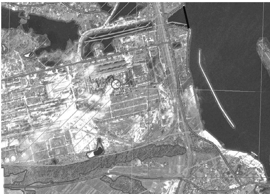
Рис. 2. Фрагмент космофотоплану на територію Канівського водосховища з відешифрованими векторними шарами берегової лінії, лісів, мостів, контурів населених пунктів, причалів, навігаційних орієнтирів
