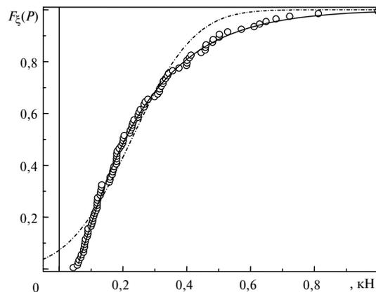
Рис. 1. Интегральная функция распределения показателя прочности порошка зернистости 400/315: эмпирическая функция (5) ( $\circ$ ), ее аппроксимация распределением Вейбулла (—) и Гаусса (----).
