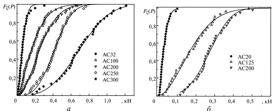
Рис. 2. Эмпирическая функция распределения прочности порошка (символы) и ее аппроксимация распределением Вейбулла (сплошная линия): 400/315 (а), 250/200 (б), 125/100 (в), 80/63 (г).
