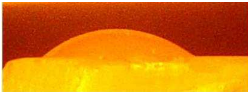
Рис. 2. Капля никеля на поверхности керамики ZrO 2 , которая одновременно находится в контакте с расплавом никель—титан (1450 °С, вакуум)
