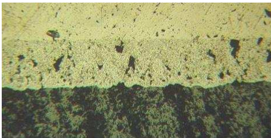
Рис. 3. Микроструктура контактной области оксид—металл для эксперимента, в котором капля никеля растекалась по поверхности керамики ZrO_2 , находившейся в контакте с расплавом никель—титан ( \times 100 , керамика внизу)
