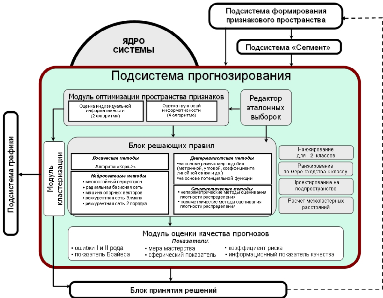
Рис. 5. Функциональная схема подсистемы прогнозирования Fig. 5. Function scheme of forecasting subsystem
