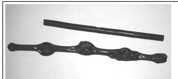
Рис. 6. Фото кабеля, подвергнутого излучению в СВЧ печи
