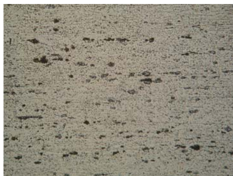
Рис. 3. Микроструктура сплава АМг6 без применения ЭДО, \times 500
