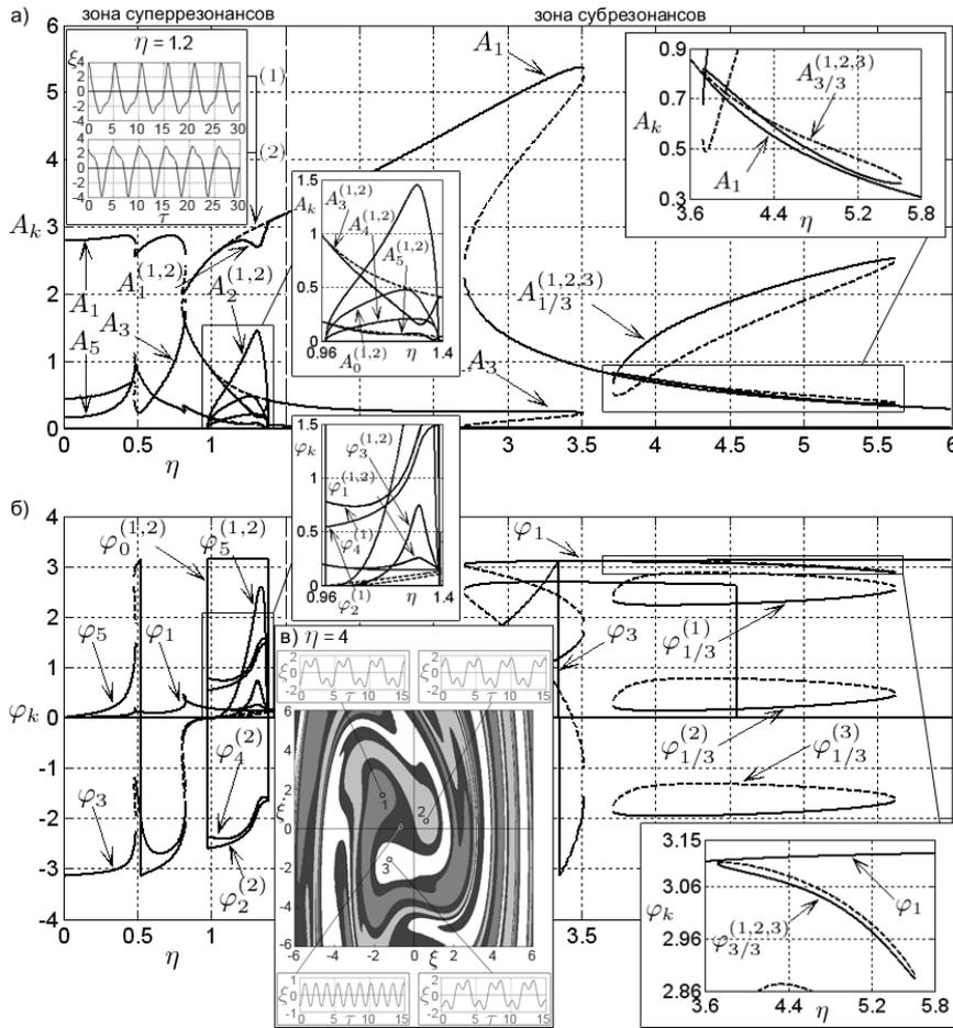
Рис. 1. АЧХ (а), ФЧХ (б) и области притяжения (в) для  $\mu\omega_0 = 0.1$ ,  $\beta = 0$ ,  $\gamma = 0.5$ ,  $P = 10$ , где  $A_k^{(m)}$ ,  $\varphi_k^{(m)}$  – амплитуда и начальная фаза  $k$ -ой гармоники  $m$ -ого режима
