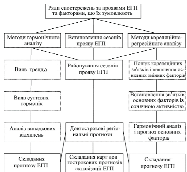
Рис. 1. Технологічна схема довгострокових регіональних прогнозів екзогенних геологічних процесів (ЕГП)
