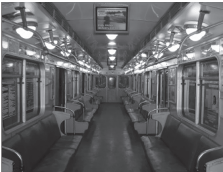
Рис. 7. Вагон Київського метрополітену, обладнаний вітчизняним світлодіодним освітленням
