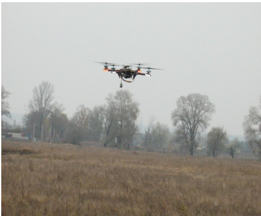
РИС. 3. Безпілотний літальний апарат для отримання даних з бездротових біосенсорів
