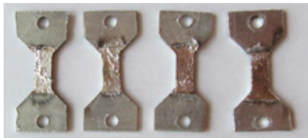
Рис. 1. Образцы алюминиевого сплава АМг6, обработанного СРЭП
