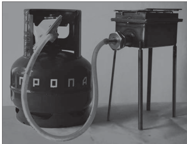
Рис. 5. Каталітичний генератор тепла на основі безполум'яного спалювання метану або пропан-бутанової суміші
