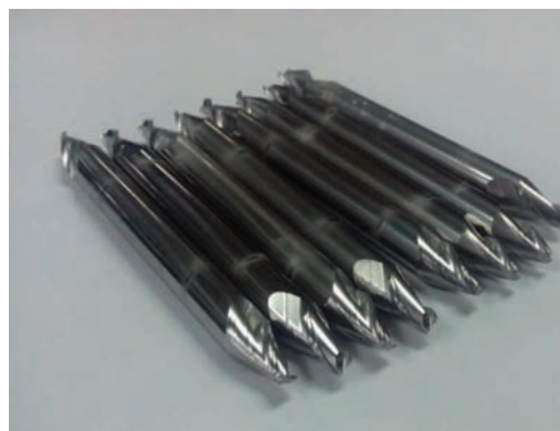
Рис. 9. Конусная фреза с многослойным вакуумно-дуговым покрытием MoN/CrN
