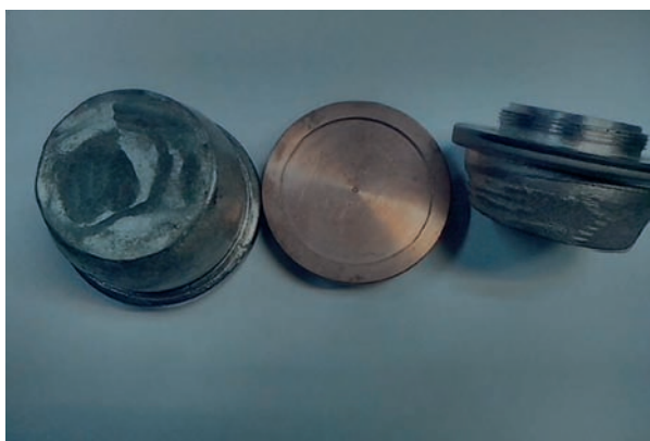
Рис. 3. Многокомпонентные катоды, паянные медно-серебряным припоем
