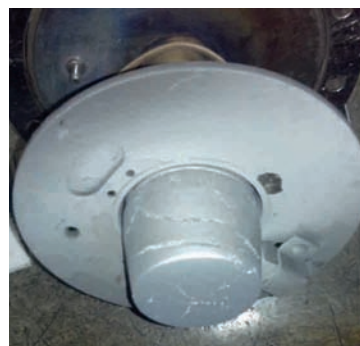
Рис. 1. Фотография паяного Сг катода с трещинами
