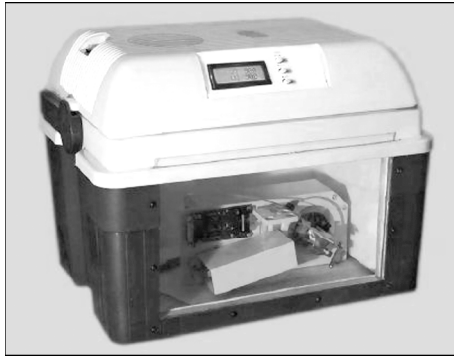
Рис. 2. Внешний вид камеры, контролирующей температуру, с работающим прибором типа «Плазмон»
