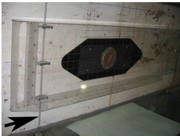
Рис. 1. Нахилена овальна лунка на обтічній поверхні пластини
