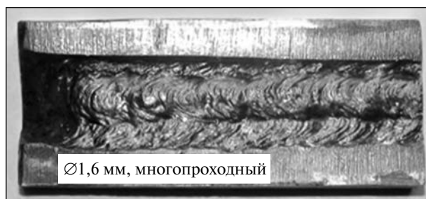
Рис. 1. Зовнішній вигляд зварних швів при мокрому підводному зварюванні високолегованої корозійностійкої сталі типу 18-10
