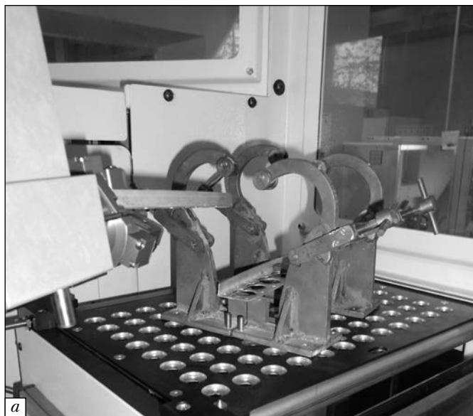
Рис. 5. Апробация программного обеспечения с помощью робота Fanuc LR Mate 200: а – установка пояса нервюры; б – собранный узел (нервюра)
