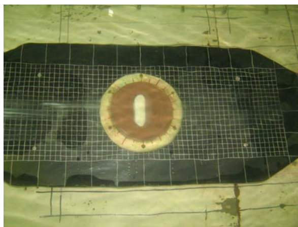
Рис. 9. Формування веретеноподібного вихору усередині поперечно обтічної овальної лунки при швидкості течії 0.5 м/с
