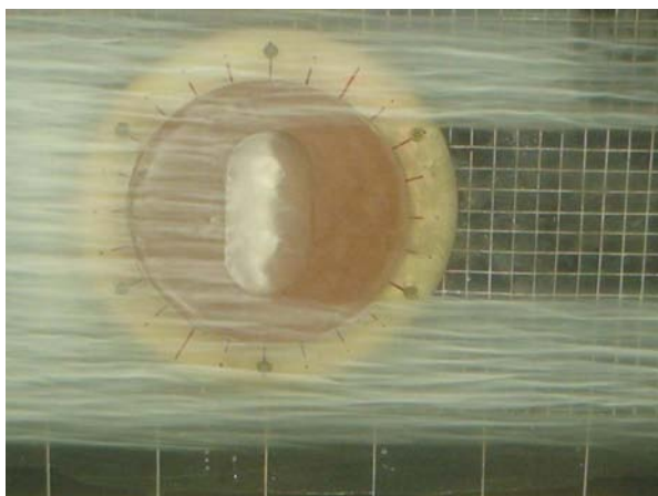
Рис. 8. Синхронний викид когерентних великомасштабних вихорів із трьох областей овальної лунки при швидкості течії 0.25 м/с
