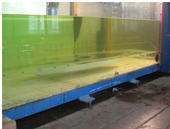
Рис. 3. Розташування пластини з овальною лункою у вимірювальному участку гідродинамічного лотку
