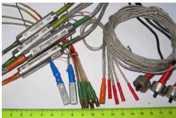
Рис. 3. П'єзореzистивні та п'єзокерамічні датчики пульсацій динамічного та пристінного тиску
