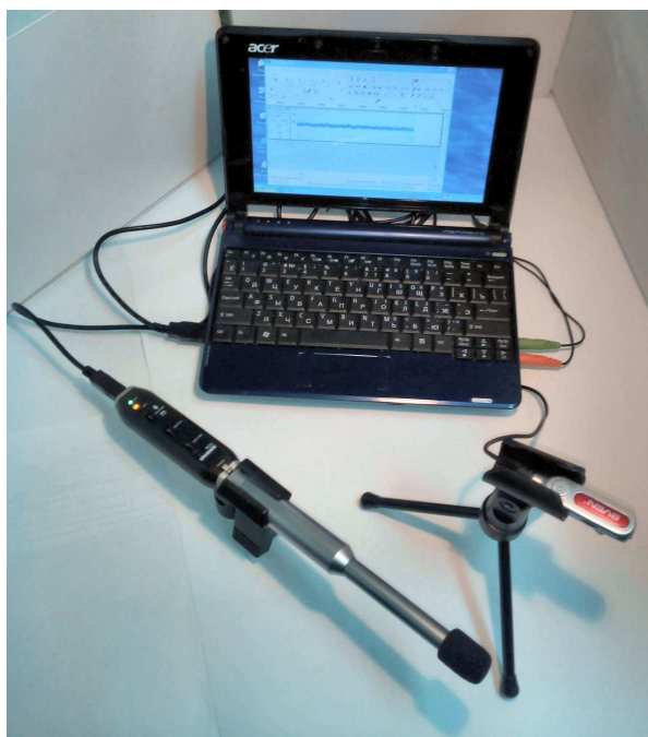
Рис. 4. На передньому плані – мікрофони Behringer ECM8000 з адаптером Shure X2U (зліва) і SVEN MK-100 (справа), підключені до нетбука ACER ASPIRE ONE
