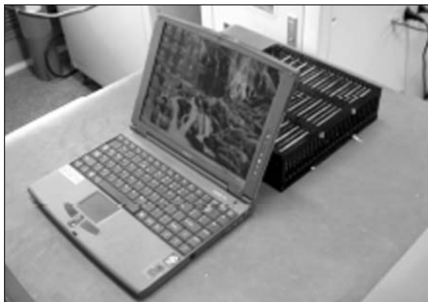
Рис. 3. Ноутбук с метаноловой ячейкой [16]
