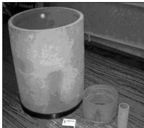
Рис. 3. Фильтроэлементы, полученные реакционным спеканием в поле центробежных сил
