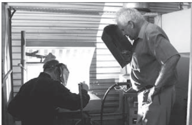
Дуговая наплавка с импульсной подачей проволоки
