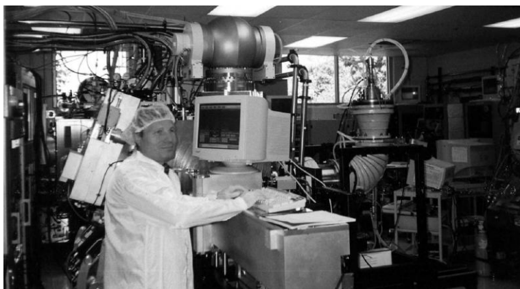
Рис. 9. Нью-Йорк (США) 2001 г. (VEECO Instruments, Inc). Тороидальный фильтр в составе промышленного оборудования для производства элементов записи и считывания информации
