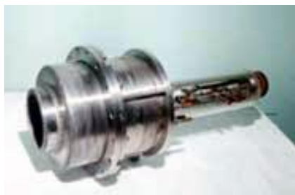
Рис. 11. Торцевые вакуумно-дуговые источники плазмы: а – для установок типа «Булат-6»; б – для осаждения толстых покрытий; в – усовершенствованная конструкция для установок новых моделей
