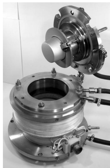
Рис. 11. Торцевые вакуумно-дуговые источники плазмы: а – для установок типа «Булат-6»; б – для осаждения толстых покрытий; в – усовершенствованная конструкция для установок новых моделей
