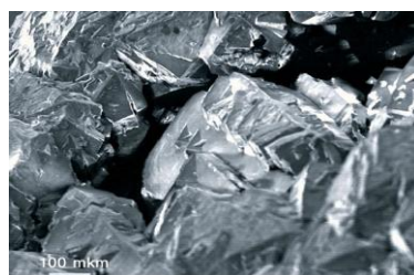
Рис. 16. Установка для синтеза алмазных пленок (а); грань синтетического монокристалла с нарощенным поликристаллическим алмазом (б, в)
