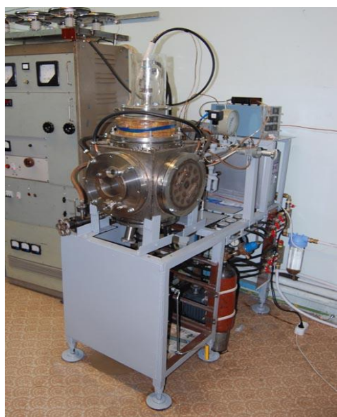
Рис. 16. Установка для синтеза алмазных пленок (а); грань синтетического монокристалла с нарощенным поликристаллическим алмазом (б, в)
