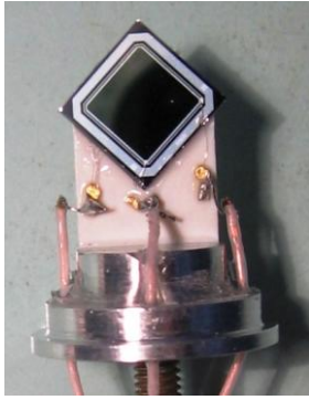
Рис. 4. Основание модуля со смонтированным детектором размером 5×5 мм (вид с фронтальной стороны детектора)
