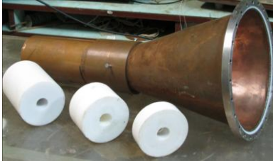
Рис. 2. Элементы волноводно-диэлектрической структуры: диэлектрические втулки длиной L = 0,25\lambda , 0,5\lambda , 1,0\lambda и дополнительный волновод с раструбом
