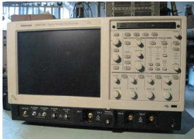
Рис. 3. Общий вид высокочастотного осциллографа Tektronix TDS 6154C с полосой пропускания 15 ГГц
