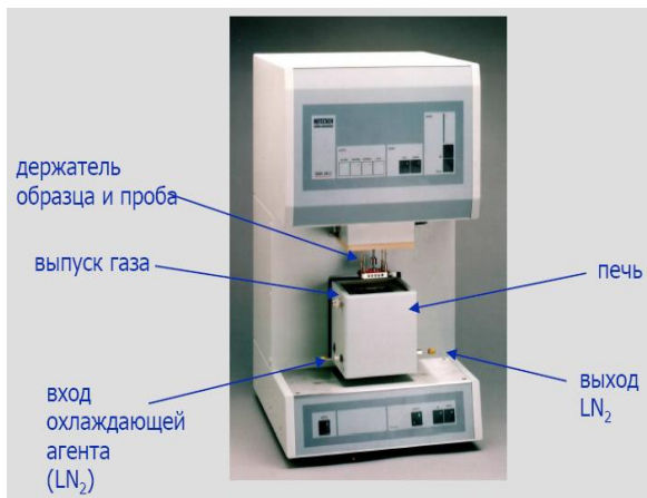
Рис. 1. Зовнішній вигляд та принципова схема аналізатора DMA 242C
